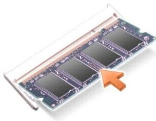
Para agregar o cambiar un módulo de memoria en el conector DIMM B:
