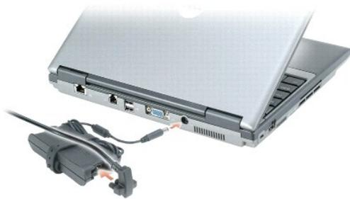
El adaptador de CA convierte la corriente alterna en la corriente continua que necesita el ordenador. Puede conectar el adaptador de CA al ordenador independientemente de que esté encendido o apagado.
