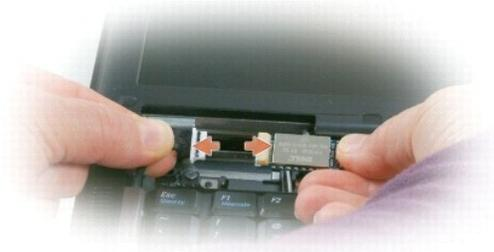
6. Desconecte la tarjeta del cable y retírela del ordenador.
