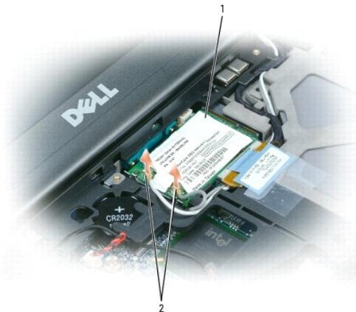
**➡ AVISO:** Para evitar dañar el conector, no utilice herramientas con el fin de separar los ganchos de fijación.
